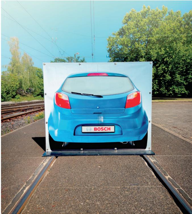
**3:** Prüfkörper für Funktionstests
